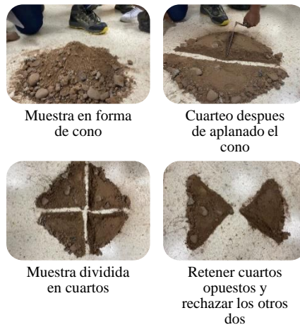
Figura 6. Cuarteo manual en muestra de agregado
