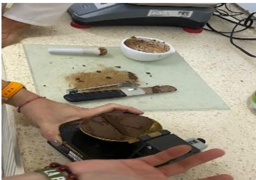
Figura 9. Equipos y elementos para determinación del límite líquido y plástico
