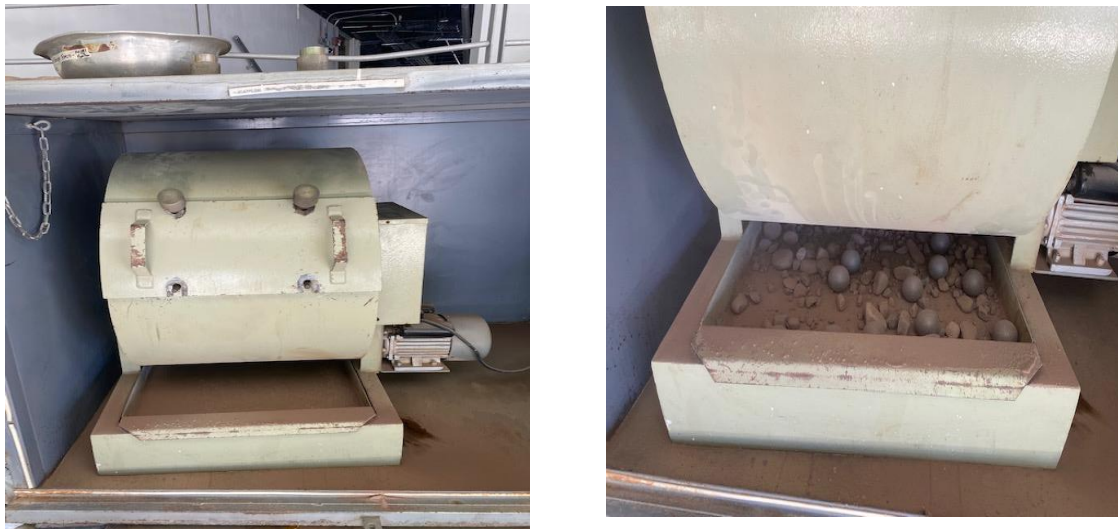
Figura 10. Máquina de los Ángeles para determinación de la Resistencia al Desgaste
