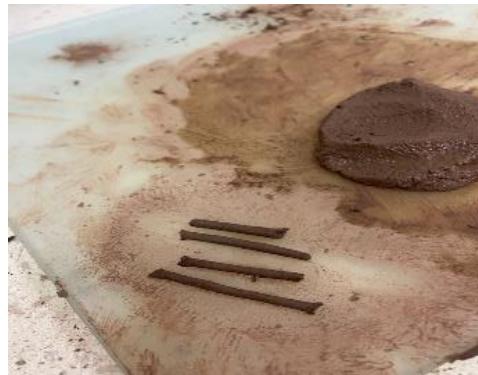
Figura 9. Equipos y elementos para determinación del límite líquido y plástico
