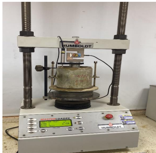
Figura 13. Máquina HM 3000 para la determinación del CBR
