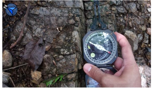
Figura 13. Falla dextralateral. Se observa el dato de rumbo del plano de la falla. Fuente: Autores.
