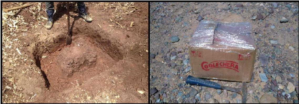
*Fotografía 13: Extracción y transporte de la muestra de suelo. Fuente: El autor.*
