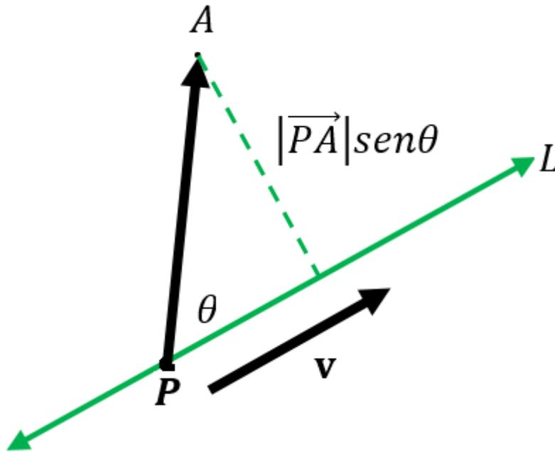
Figura 11 Ilustración de la distancia de un punto a una recta en el espacio
