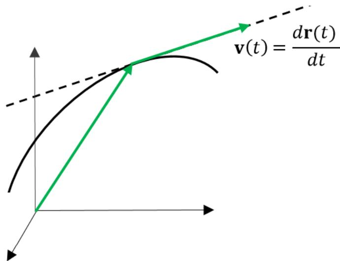
Figura 3. Ilustración del significado geométrico de la velocidad de una curva
