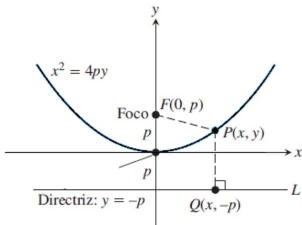
Figura 6. Conjunto de puntos equidistantes de un punto fijo y una recta fija
