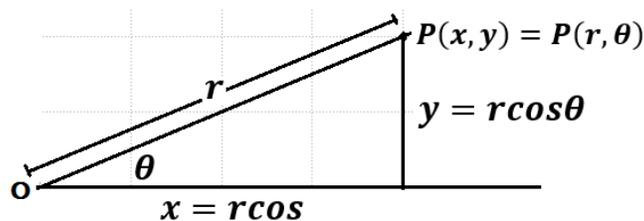
Figura 2: Representación de un punto en coordenadas polares
