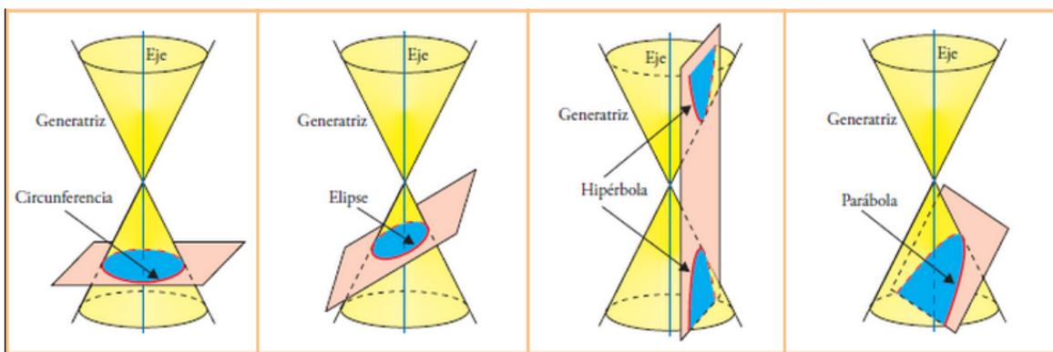
Figura 5. Corte de dos conos coaxiales de vértice común cortados por plano para producir secciones cónicas
