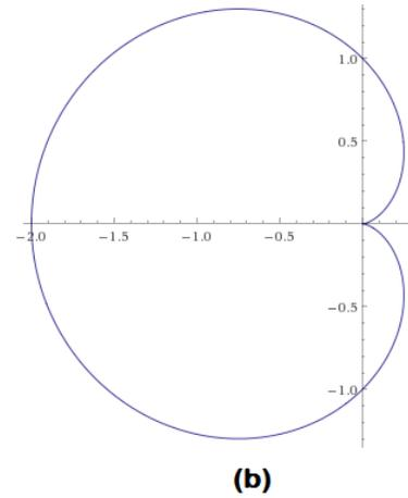
Figura 4: gráfica de  $1 - \cos\theta$ . En (a) se grafica en  $[0, \pi]$  en (b) se aplica simetría respecto a X para obtener la curva en  $[0, 2\pi]$
