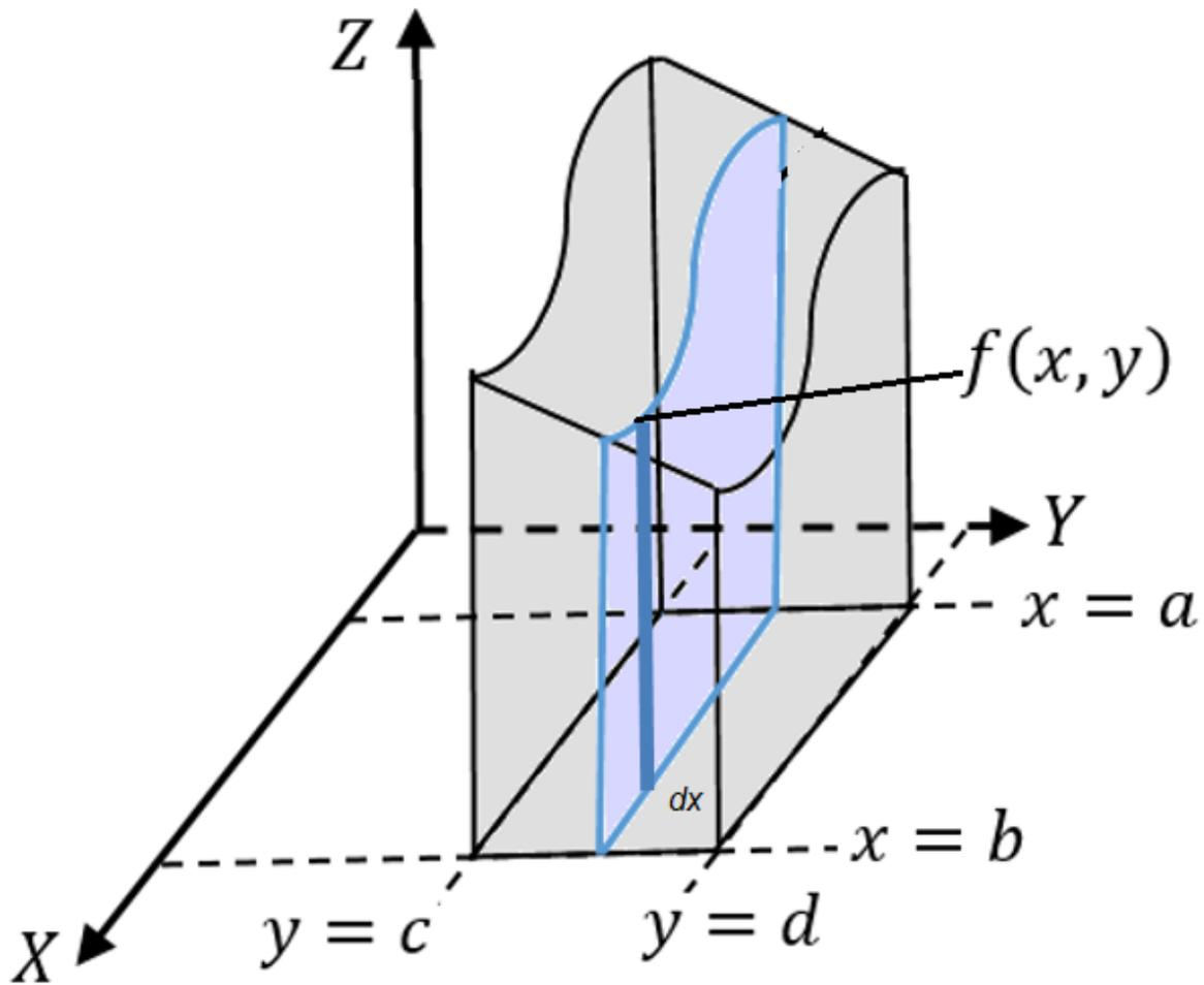
Figura 4. Ilustración del razonamiento para calcular una integral doble sobre una región rectangular
