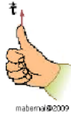
Figura 10. La dirección del torque es la dirección del dedo pulgar de la mano derecha, cuando se enrolla los otros dedos en la dirección que gira el cuerpo.
