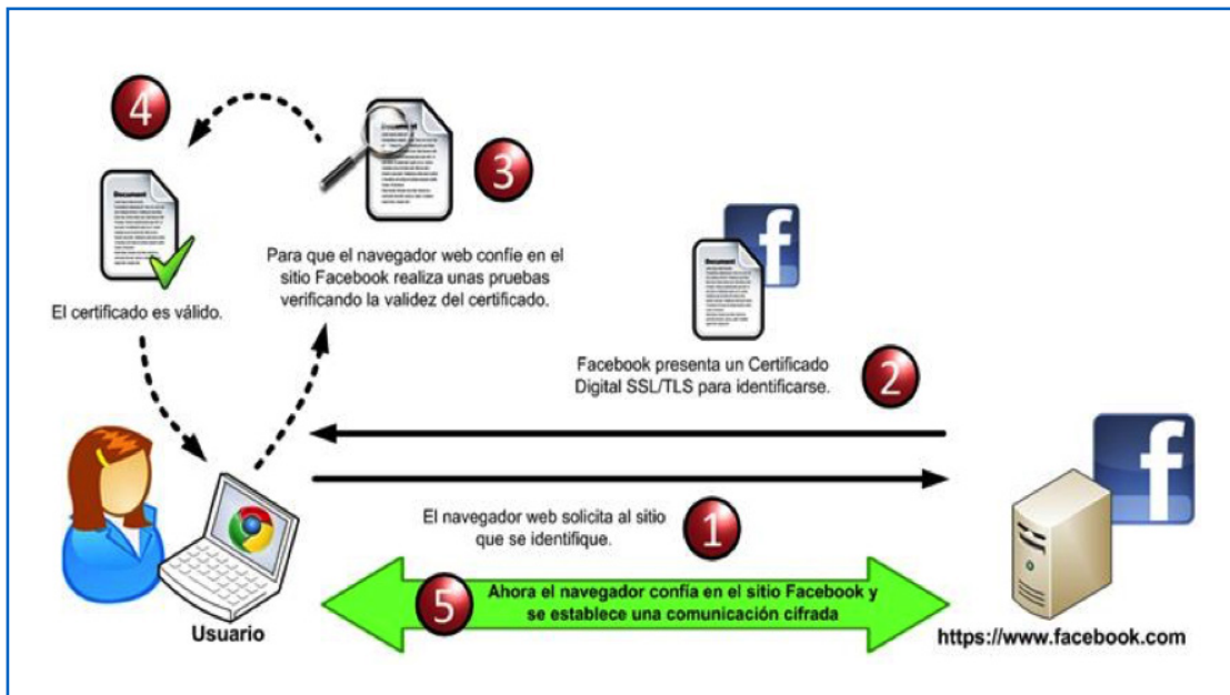
Imagen 2. Funcionamiento general de SSL/TLS Fuente: http://revista.seguridad.unam.mx/numero-10/el-cifrado-web-sslts
