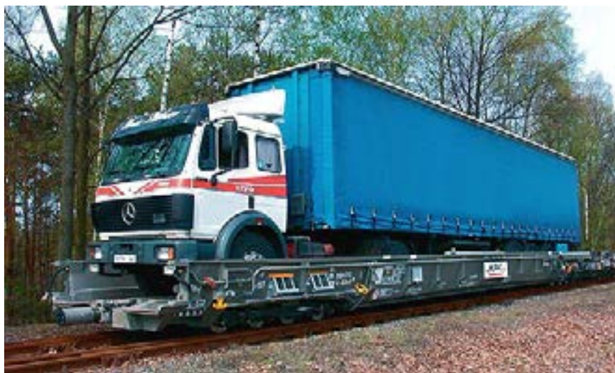
Imagen 1. Modelo de transporte sobre vías férreas con ruedas pequeñas
