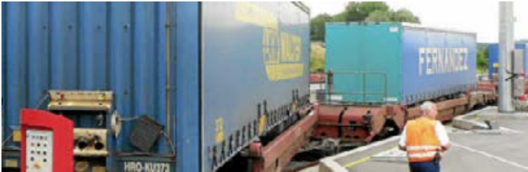
Imagen 2. Modelo de transporte sobre vías férreas con ruedas convencionales
