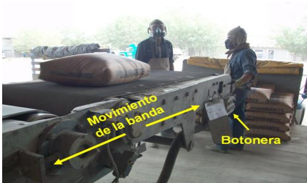
Fotografía 9. Banda Telescópica para cargue de sacos de cemento.
