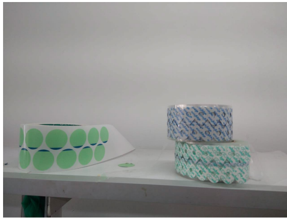
Figura 26. Diferentes cintas para proteger el lente en el proceso de bisel Fuente: Imagen propia
