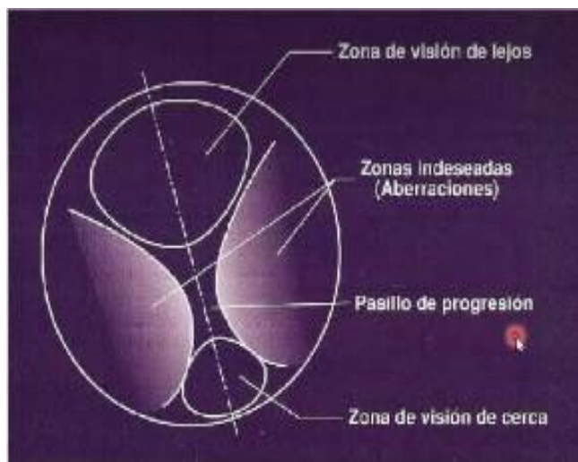
Figura 6. Lente progresiva, muestra el pasillo de visión lejana, intermedia y la zona de cerca, también se puede apreciar la zona de aberración
