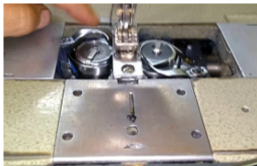
Ilustración 25 Mecanismo interno de Máquina Doble aguja. Fuente: http://cyberspaceandtime.com/EjiiLFukGk.video+related
