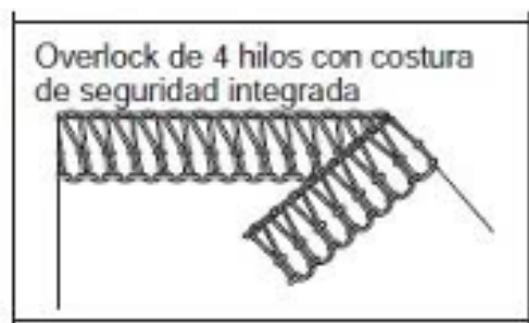
Ilustración 23 Puntada de la máquina fileteadora. Fuente: https://donomaq.com.ar/para-que-sirve-cada-puntada-de-la-overlock/
