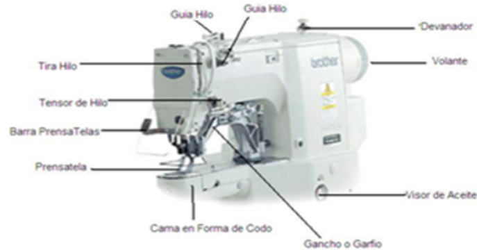
Ilustración 30 Partes de la Máquina Presilladora. Fuente: http://rossyamigadelaaguja.blogspot.com/2011/11/maquina-presilladora-partes-enhebrado.html
