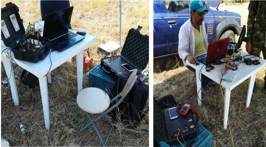
Figura 14. Equipo de resistividad MINISTING IP
