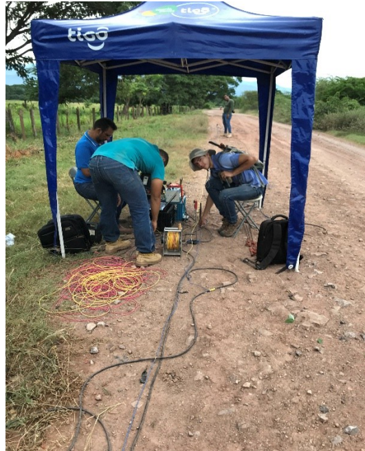
Figura 23: Prospección Geoeléctrica (SEV)
