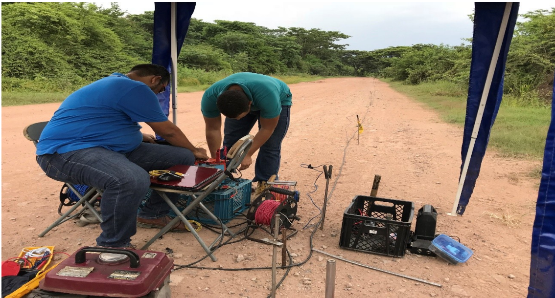
Figura 20: Prospección Geoeléctrica (SEV)
