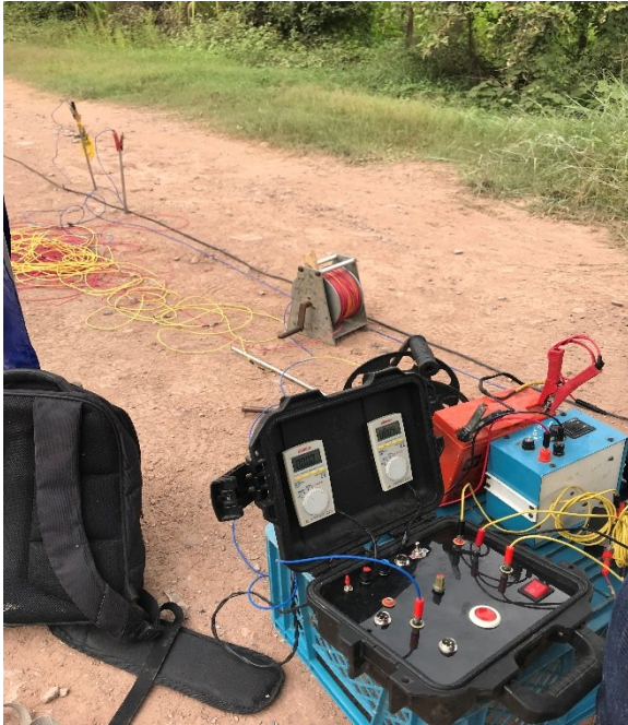
Figura 22: Prospección Geoeléctrica (SEV)
