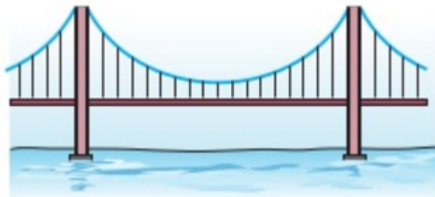
Figura 3. Cable de suspensión de un puente
