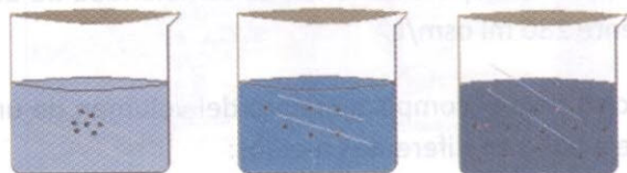
Figura N° 14: Difusión de un colorante en agua
