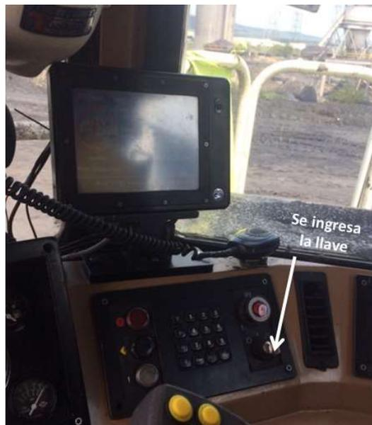
Ilustración 26. Acceso a la configuración del cargador
