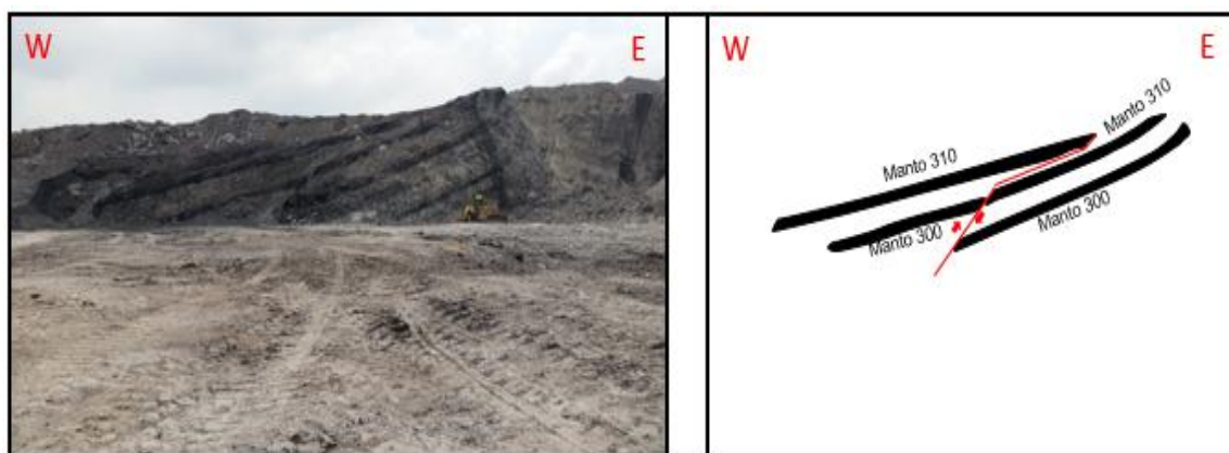
Figura 28. Desplazamiento del manto 310 y 300, afectado por la falla E2 asociada a la Falla Carolina.
