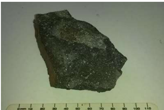
Figura 8. Muestra GLJY-007 roca ígnea volcánica según Streckeisen, 1976, es una Dacita asociada a la Formación Riolita de Goleros (Jg).
