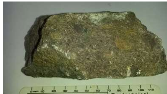
Figura 4. Muestra GLJY-026 de una Toba Traquítica según el Diagrama de Streckeisen, 1976 y se asocia a la Fm. Guatapurí
