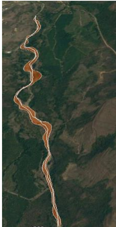
Figura 10. Polígono para determinar los factores topográficos del río Sororia. Fuente: Google earth
