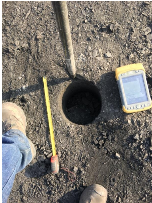
Fotografía 6: Techo limpio del manto atravesado por un pozo.
