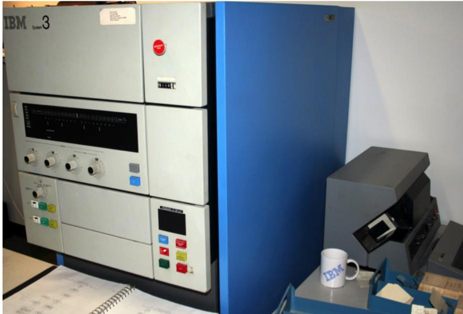
Imagen 17. Equipo de cómputo, usado en los 80 del siglo XX, por tarjetas perforadas
