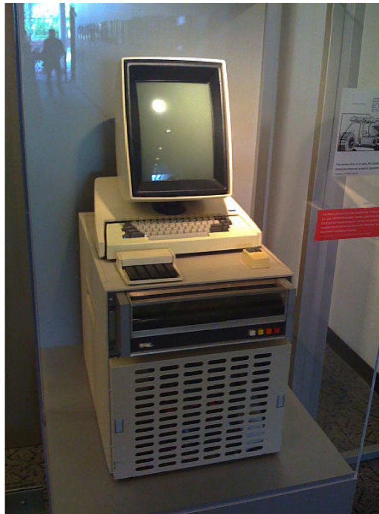
Imagen 19. Computador Xerox Alto, 1973, con interface gráfica tipo Windows
