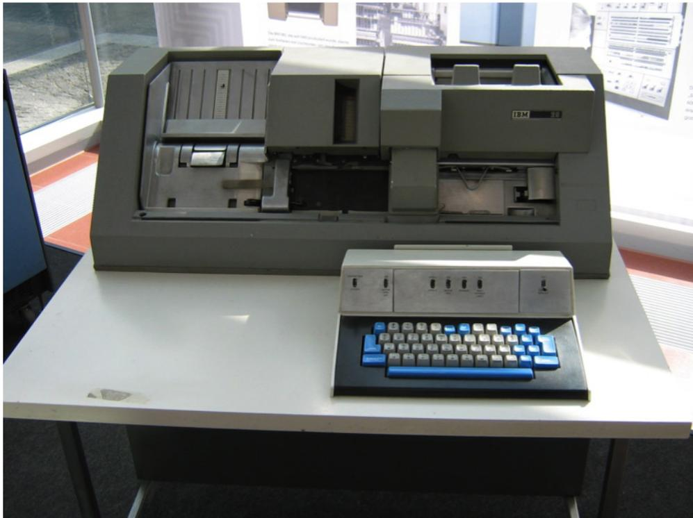
Imagen 18. Equipo de cómputo, usado en los 80 del siglo XX, por tarjetas perforadas, perforadora
