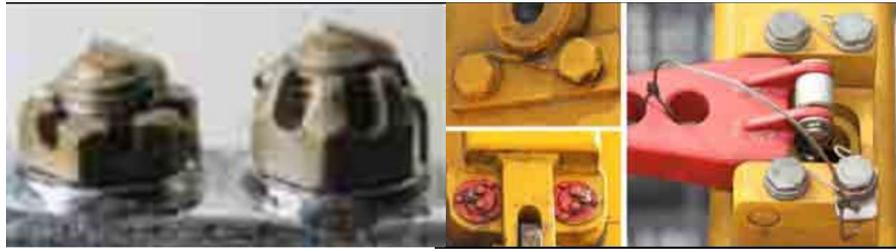
**Figura 1. Ejemplos de aseguramiento de objetos en la industria de Hidrocarburos**
