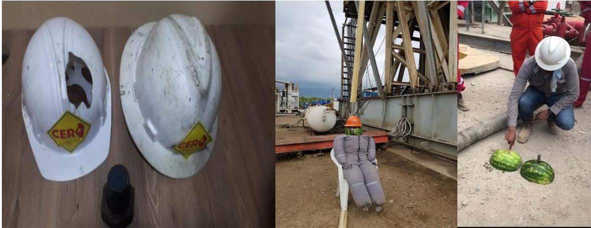
**Figura 3** Simulación del impacto en una persona por caída de objetos.
