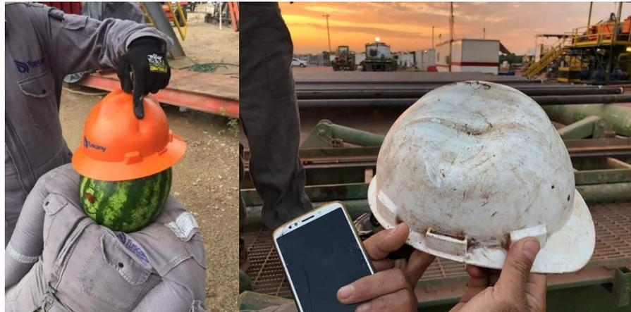
**Figura 4.** Ejercicios simulados en equipos de perforación como parte de entrenamiento, en caída de objetos a diferente altura y pesos.
