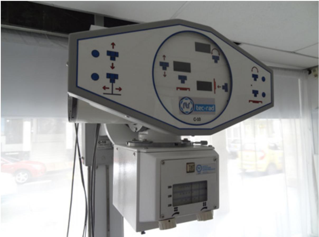
Figura 12. Caja de colimadores con luz halógena de posicionamiento.
