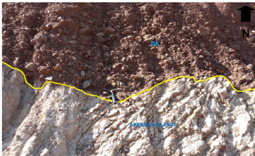
Figura 18. Depósito Aluvial (Da) en la parte superior y en la inferior se observa una arenisca blanca.
